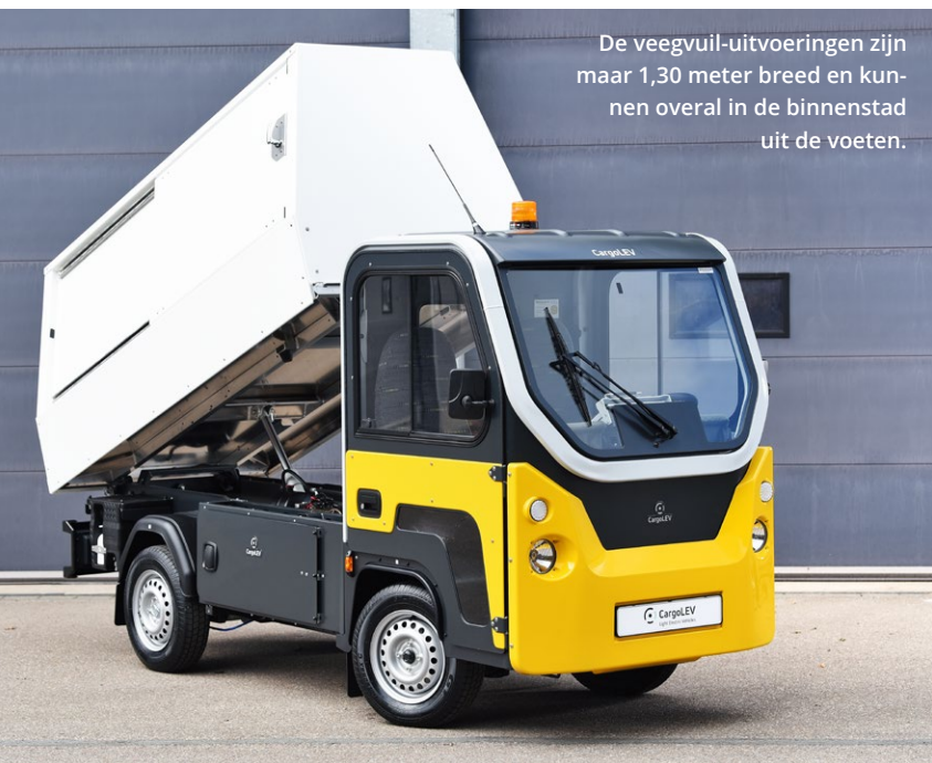
Een CargoLEV TC met gesloten laadbak in XL-uitvoering. Dankzij de voorwielaandrijving is de laadvloer aangenaam laag.
